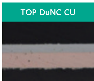
従来品: ピットを生じやすい Conventional bath: cause pit easily
